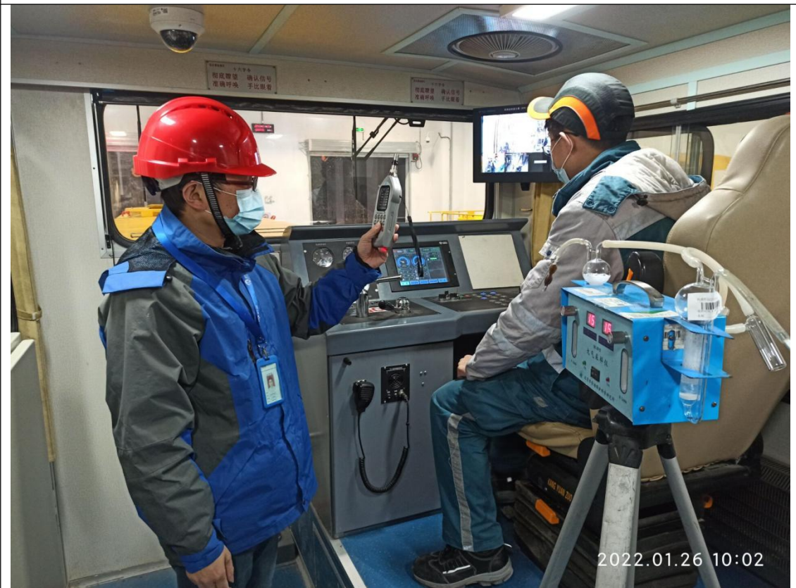
备注：杭州地铁双浦车辆段工程车库氮氧化物和噪声检测
