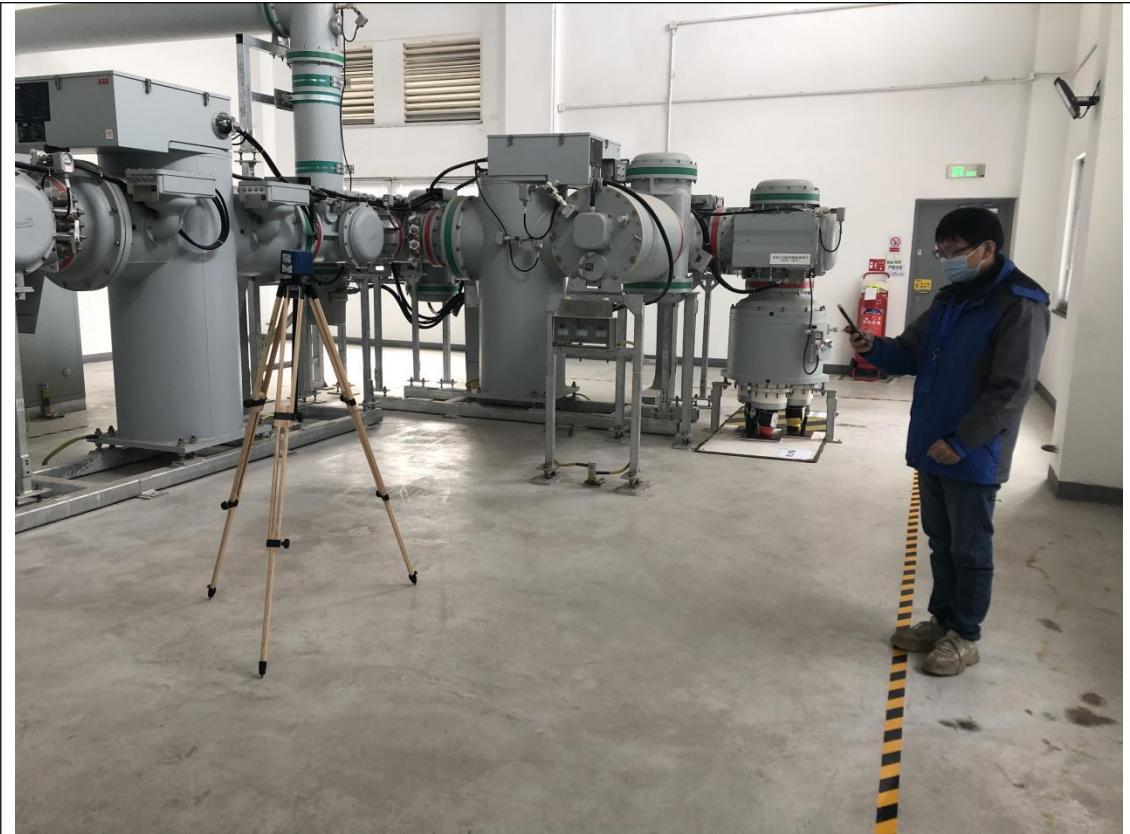
备注：杭州地铁6号线铁平澜主变电所工频电场检测
